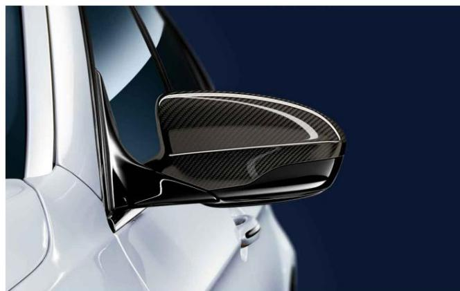
Coque de rétroviseur extérieur M Performance carbone M5 (F10M)
